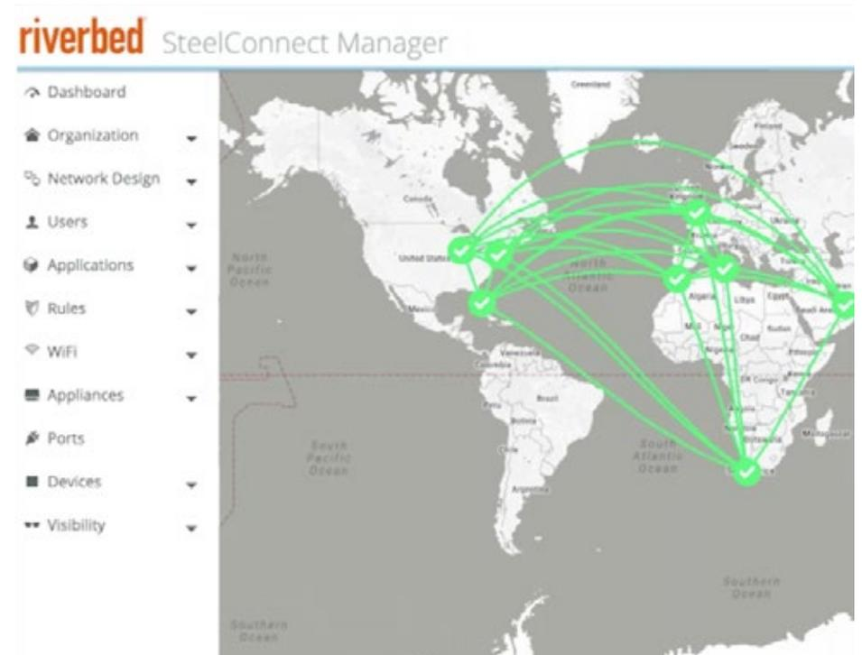
Figure 2 – La gestion du SD-WAN s'effectue depuis une console centrale à interface graphique intuitive, plutôt que via des CLI propres à chaque équipement réseau. Cet écran fournit un aperçu de l'état de fonctionnement de toutes les connexions WAN inter-sites.
